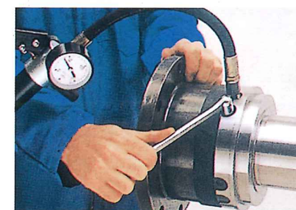
(5) 持续加油直至压力表指着所需值为止。谨慎按拧紧扭矩拧紧剪切管。任何一个安全装置附有校正图（图12）。
