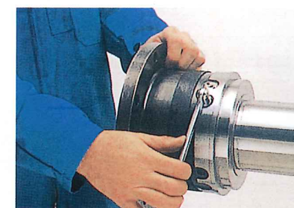
(2) 利用规定的扭矩拧紧新的剪切管，并将剪切管的端部固定在轴上。
