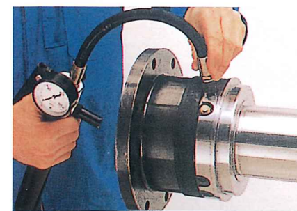
(4) 连接泵，旋转剪切管1/8周（即加油口连接部的通道打开）。
