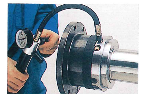
(6) 降低泵内的压力后拆除气氛。安装保护销。这样安全装置就可恢复到工作状态。可周而复始的操作，连续不断的使用(全部过程仅花费数分钟)。
