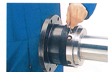
(3) 压力设定：使用设备的螺钉（M8），从加油口连接部上取下保护销。
