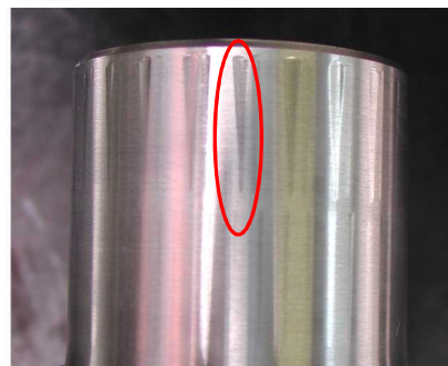
図10 クロスピンの転動面の損傷例
