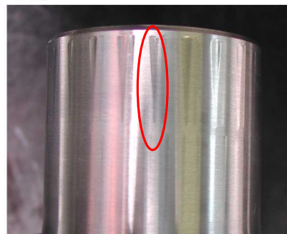
図10 クロスピンの転動面の損傷例
