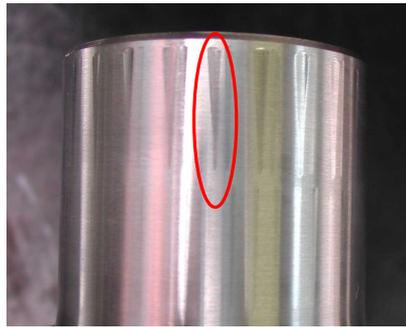
図14 クロスピンの転動面の損傷例
